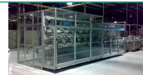
Guardas de protección
